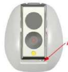
Рис. 7: для снятия крышки необходимо разблокировать защелку.
