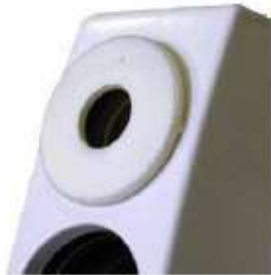
Рис. 14: диафрагма, помещенная перед оптическим блоком приемника
