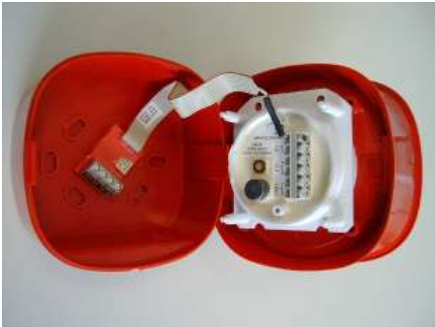
Рис. 2. Установка интерфейса SDI 82/1 и диода
