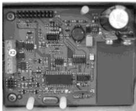
Рис. 2. Интерфейс радиомодуля BX-RGW
