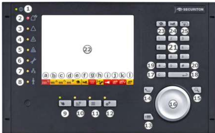
Рис. 1. Краткое описание главной панели индикации и управления MIC
