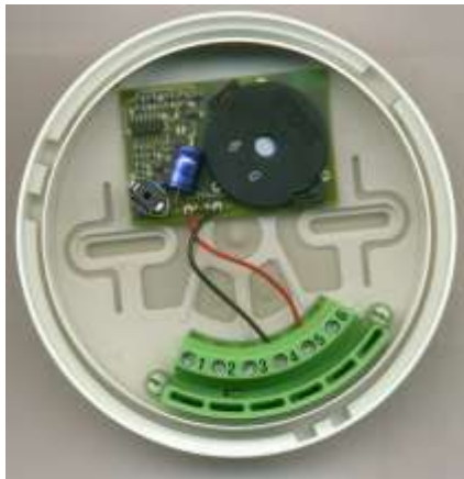
Рис. 2. Положение сирены SIR715 внутри основания детектора
