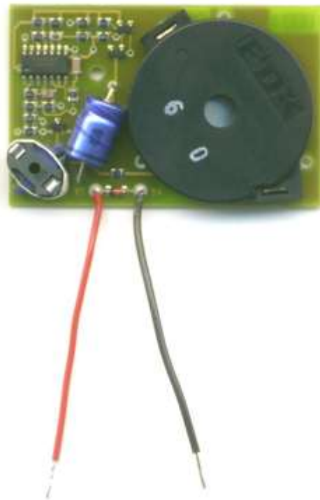
Рис. 1. Сирена для монтажа в основание SIR 715
