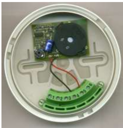
Рис. 2. Положение сирены SIR715 внутри основания детектора
