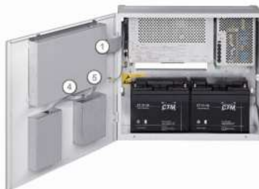
Рис. 5. ПКП 2000 вместе с картой В6-MIC11
