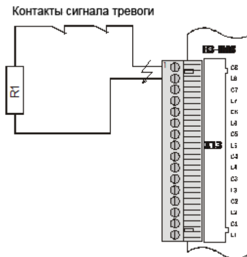
Рис. 15. Подключение саботажной линии
