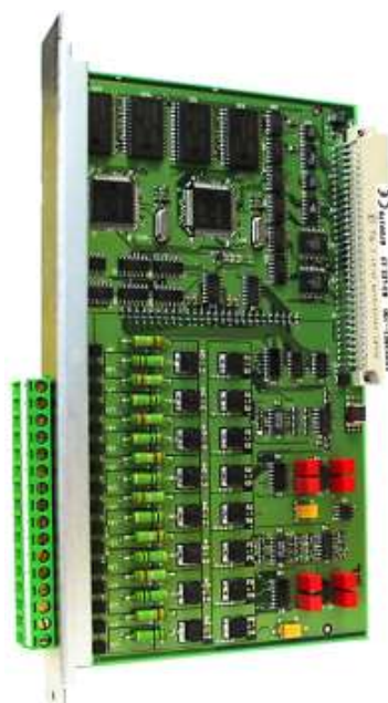
Рис. 1. Плата линий пожарной сигнализации В3-LEE23 для детекторов НХ 140
