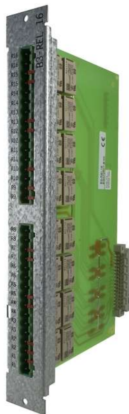
Рис. 1. Релейная плата В3-REL16 с напряжением на контактах 24 В
