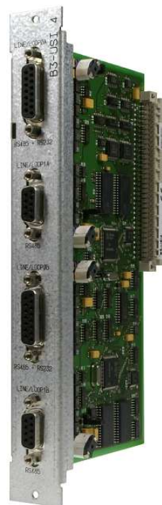
Рис. 1. Универсальная интерфейсная плата В3-USI4
