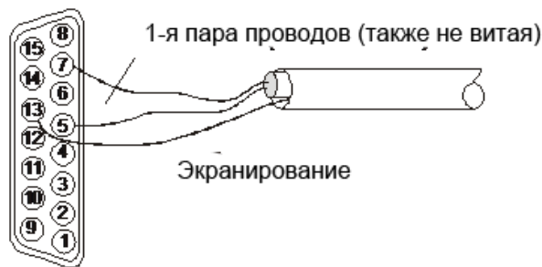
Рис. 3. Назначение разъемов с экранированным кабелем
