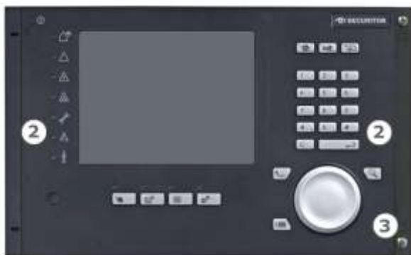
Рис. 3. Лицевая сторона панели В5-MIC11
