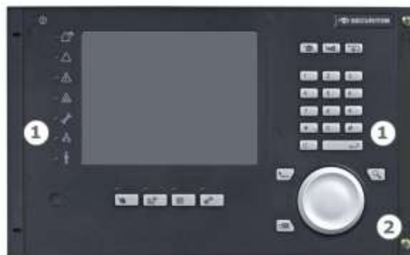
Рис. 5. Лицевая сторона панели В5-MIC711
