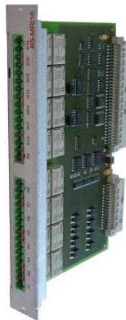
Рис. 1. Релейная плата B5-MR116 с контактами напряжением 24 В
