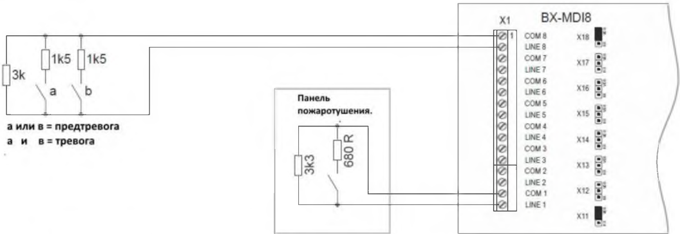
Рис. 11. Контроль насосов, входов системы пожаротушения, в соответствии с VdS.
