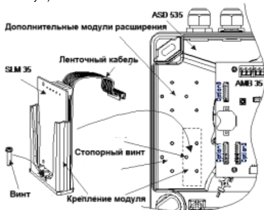
Рис. 2. Установка модуля SLM 35
