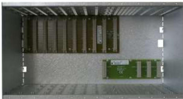
Пустая модульная стойка с соединительными платами для шин
