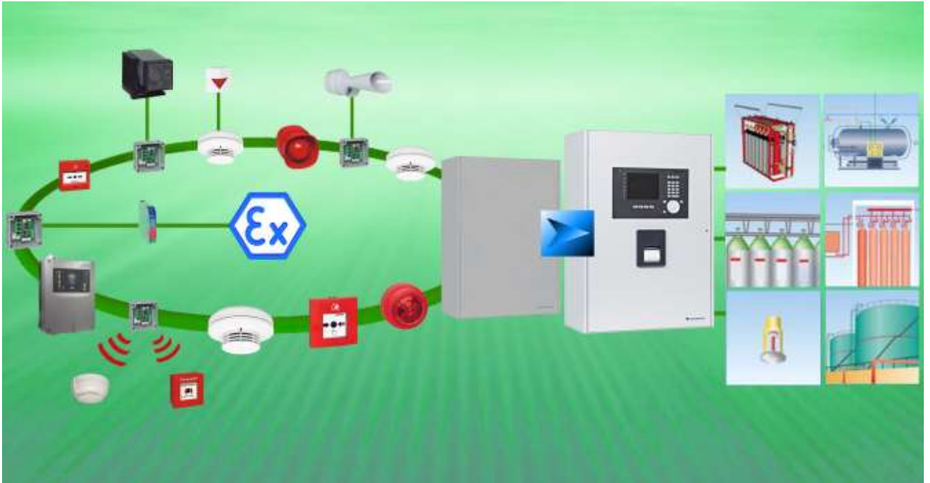
Топология системы SecuriFire SCP, построенная на основе приемно-контрольных приборов для систем пожаротушения ЕСР
