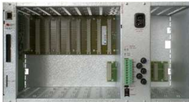
Модульная стойка, оснащенная PSB и MCB (блоком питания и материнской платой)
