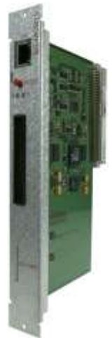
Резервность центрального пульта управления SecuriFire B5-MCB15
