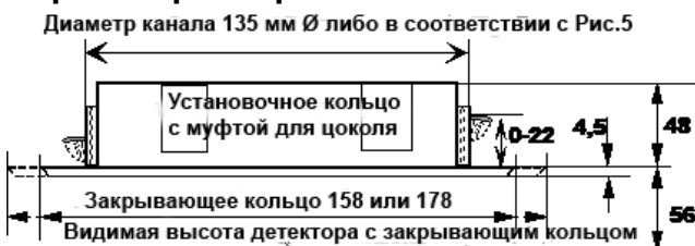
Рис. 2. Чертеж цоколя USB501-2 с размерами
