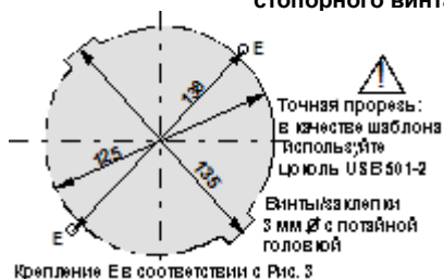
Рис. 5. Монтаж цоколя USB 501 с помощью заклепок или винтов
