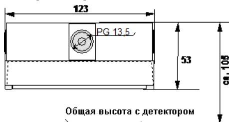
Рис. 2. Чертеж цоколя USB501-3 с размерами
