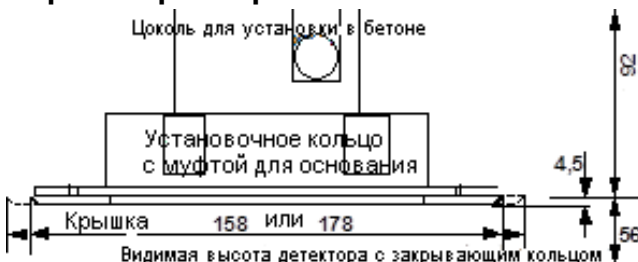
Рис. 2. Чертеж Цоколя USB501-4 с размерами
