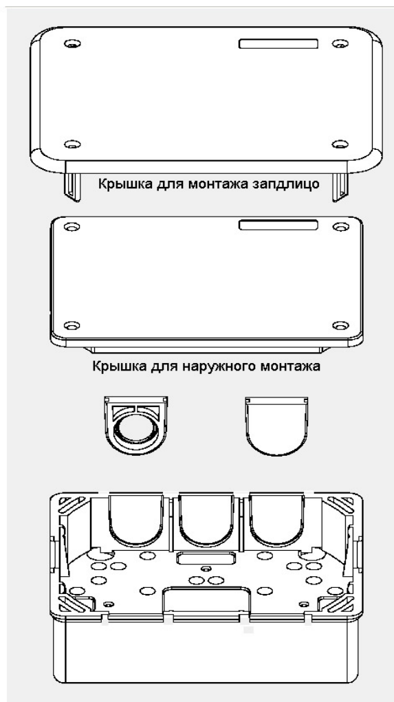
Рис. 1 DOS 816 с крышкой и кабельными входами
