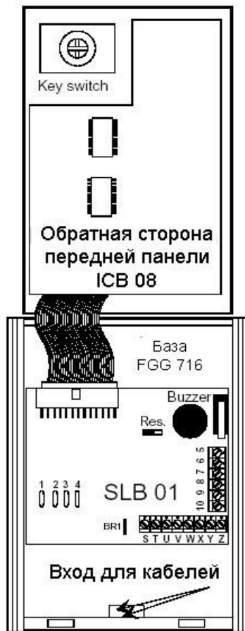
Рис. 3 Конфигурация KIM 731 и FGG 716
